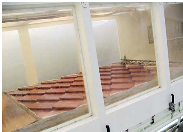
→ Die Testfläche für den neuen Ziegel in der Windkanalkammer.
