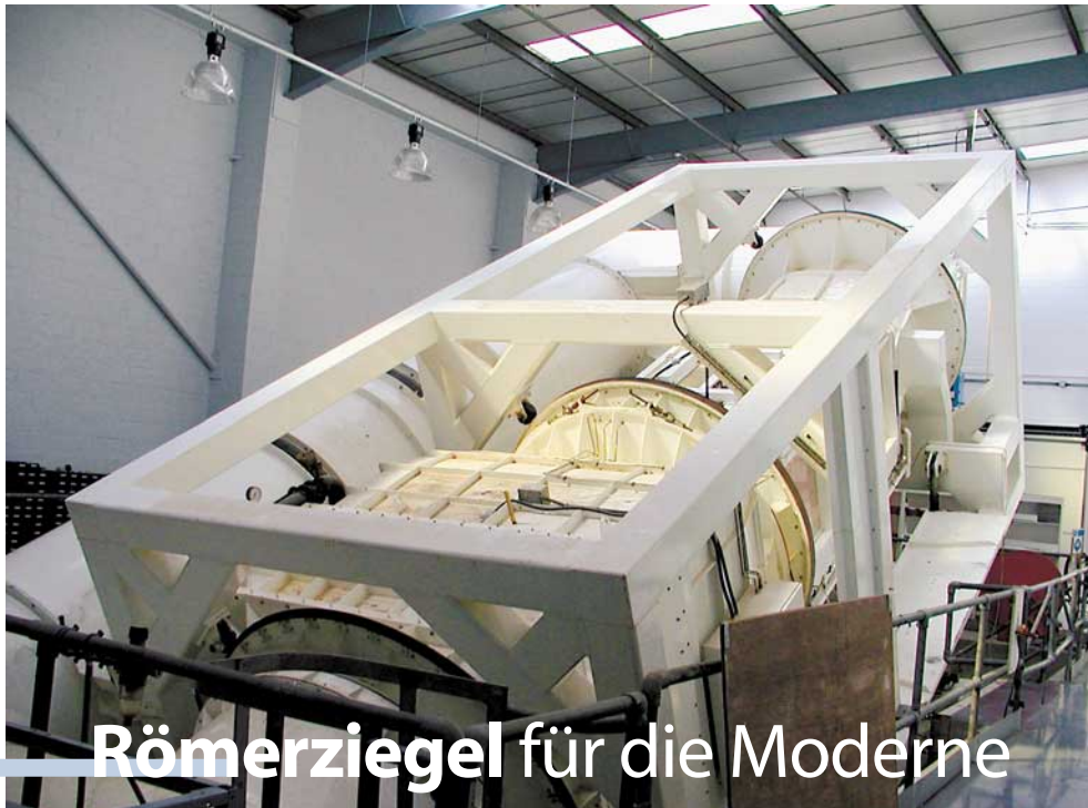
← Die Windkanal-Testeinrichtung in gekippter Stellung.
